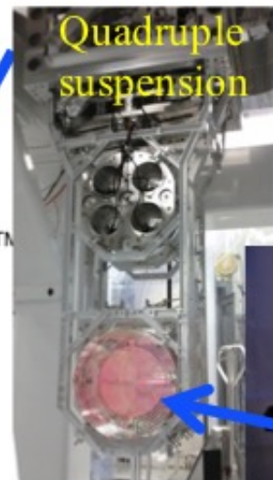
40kg test mass 34cm \phi x 20cm
